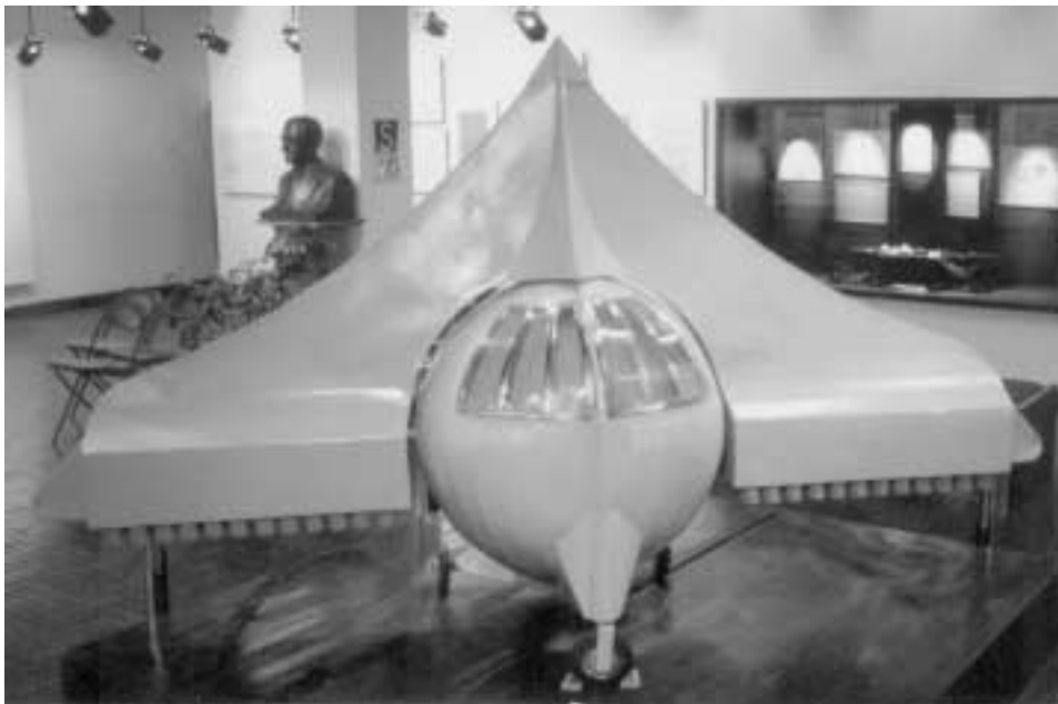
Este modelo del Avión Torpedo de Paullet muestra claramente las hileras de cohetes bajo el triángulo con forma de punta de lanza, y la cabina ovoidal y sus ventanillas. Puede apreciarse el busto de Paullet en la parte superior izquierda de la fotografía.
