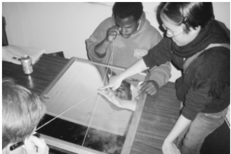
Foto 1. La luz de la linterna “sabe” cómo seguir la trayectoria de menor distancia. El autor (izq.) apunta la linterna, desde la altura de su ojo, hacia el espejo, y de ahí hacia el ojo de su compañero (der.). Cada uno sostiene una cuerda a la altura de su ojo, al tiempo que una compañera presiona la cuerda con su dedo justo donde la luz se refleja en el espejo. Para mover su dedo de allí, sobre la superficie del espejo, necesita que aflojen la cuerda. (Foto: Sylvia Spaniolo).
