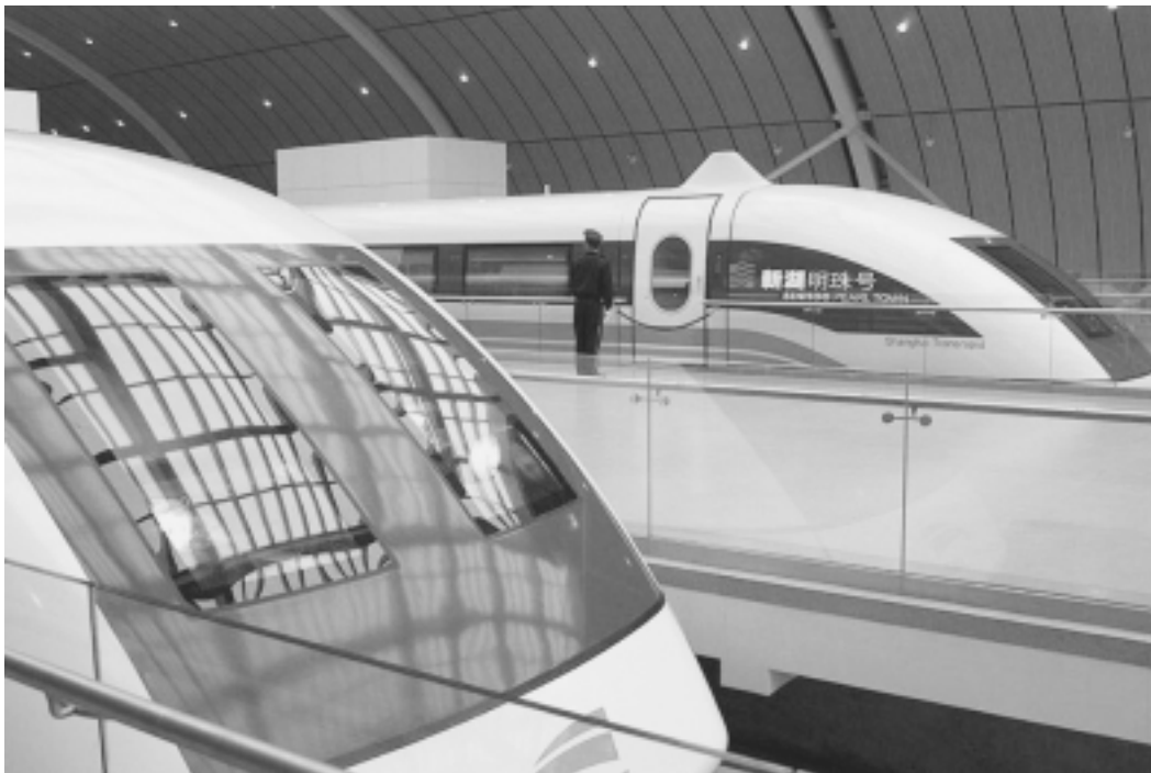
El desarrollo de la infraestructura eurasiática exigirá nuevas tecnologías para el transporte terrestre de alta velocidad, tales como los sistemas ferroviarios de levitación magnética o maglev. Usando la tecnología del sistema del Transrapid alemán, un tren maglev conecta ahora la ciudad de Shanghai con su aeropuerto. (Foto: Transrapid).
